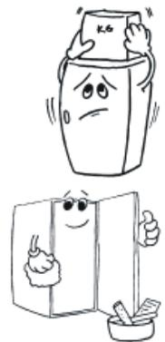
Ремонт холодильника <http://rembitteh.ru/> Когда холодильник находится рядом с морозильным аппаратом для глубокого замораживания, между ними должно быть, по крайней мере, 2 см для предотвращения влаги на поверхности. Не ставьте ничего на холодильник. Установите его в подходящем месте так, чтобы оставался зазор, по крайней мере, в 15 см с верхней стороны.
